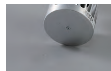
仕上げマグで適切加熱。接合完了の刻印が目視管理。
