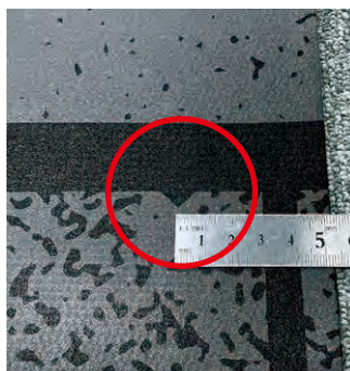
シート接合幅の基準となるマークが柄の中に仕込まれています。
