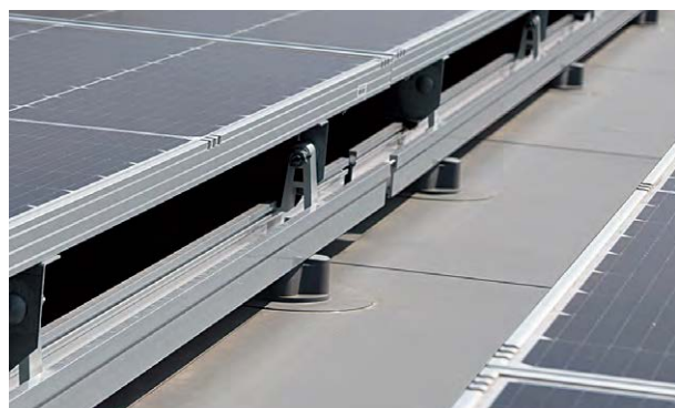
連結ディスクADCはアンカーで躯体に固定したのち、ツバ部分をリベトルーフと溶融着接合で一体化させます。
